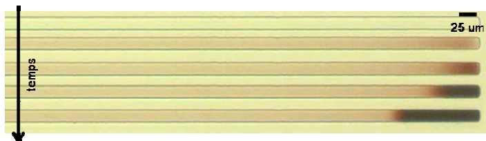
Figure 1 : Suivi au cours du temps de la couleur de la solution dans le canal de microévaporation. Le réservoir est à gauche, le bout du canal à droite.
